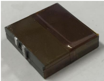
Planar inductor 692\text{nH}@15\text{MHz} R_{\text{DC}}=5\text{m}\Omega , R_{\text{AC}}=484\text{m}\Omega@15\text{MHz}
