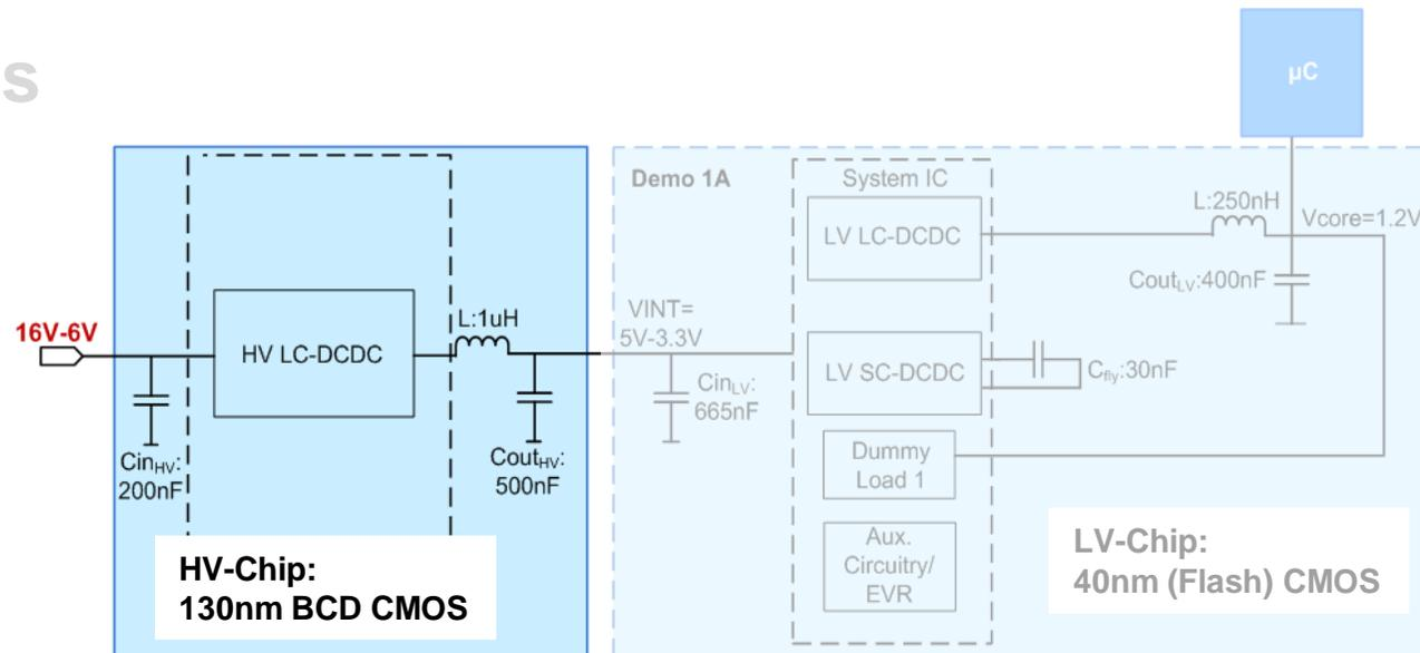
$V_{in}=12V$ ,  $f_{sw}=10MHz$ ,  $ESR_L=500m\Omega$ ,  $ESR_{COUT}=50m\Omega$ ,  $ESR_{CHS}=100m\Omega$ ,
